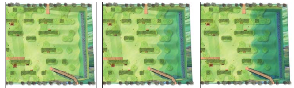
Exemple de système de rétention à ciel ouvert (ici le Square des Acrobates (Saint-Denis) avec la mise en charge progressive des espaces verts)
